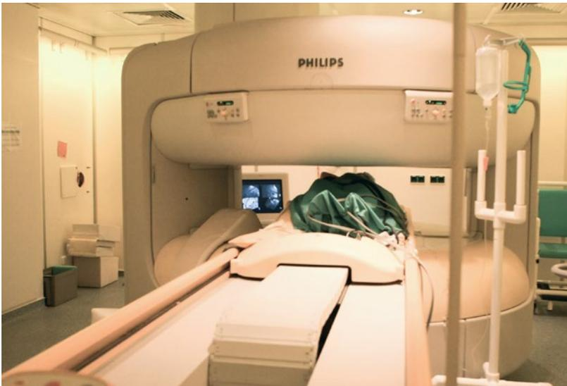
■ **Abb. 2.4** Offener 1-Tesla-Magnetresonanztomograf (Fa. Philips Medical, Niederlande) mit weitem Zugang von lateral. Ein in unmittelbarer Nähe platzierter Bildschirm ermöglicht das fluoroskopische Monitoring der Intervention
